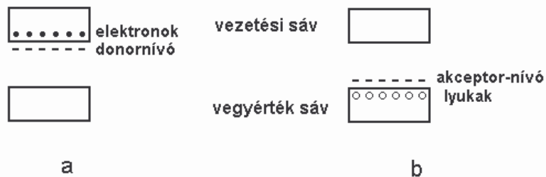
2. ábra. a: n-típusú, b: p-típusú félvezető sávszerkezete
