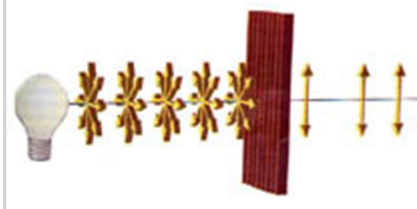
5. ábra: Lineárisan polarizált fény előállítás polarizátorral forrás: http://www.vilaglex.hu/Lexikon/Html/Polariza_.htm
